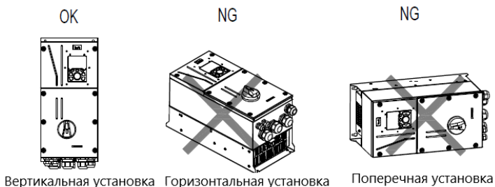
Рис 4.1 Ориентация ПЧ при установке
